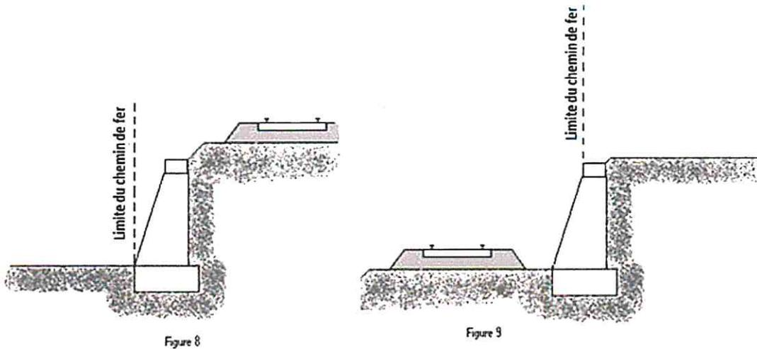
Lorsque le chemin de fer est établi en remblai et que le talus a été rechargé ou modifié par suite d'apport de terre ou d'épuration de ballast, la limite du chemin de fer pourra être déterminée à partir du pied du talus primitif, à moins toutefois que cet élargissement de plate-forme ne soit destiné à l'établissement prochain de nouvelles voies.
