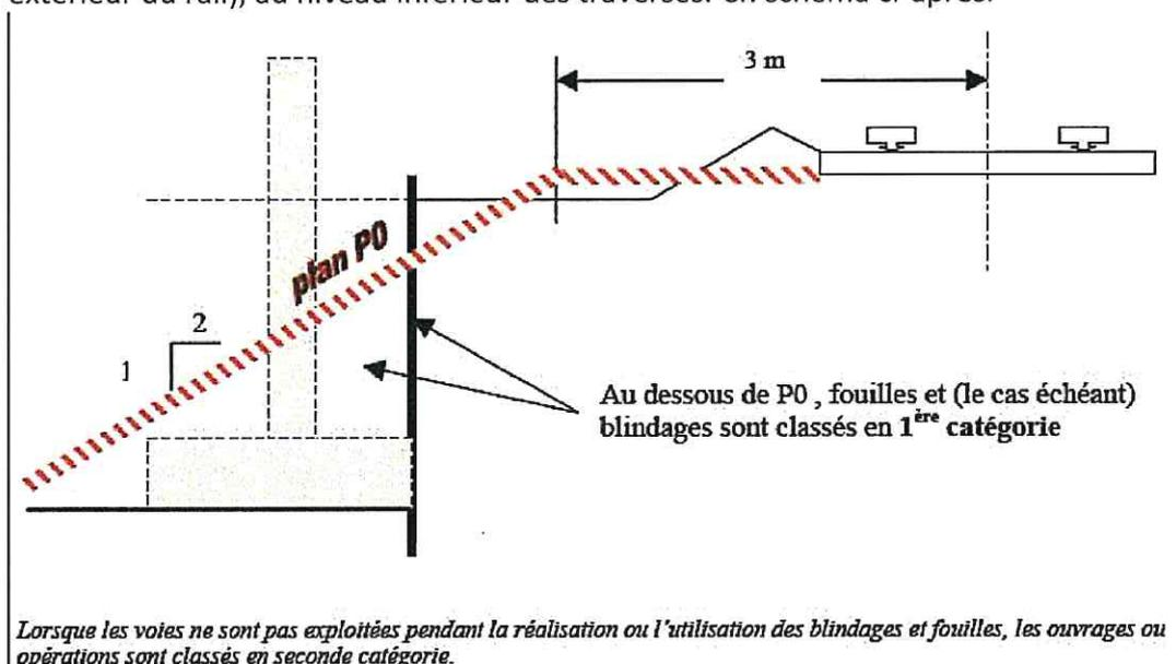
Nota : l'exécution de terrassements (fouilles, déblais ou remblais) à moins de 3 mètres de l'axe d'une voie ferrée exploitée est interdite.
